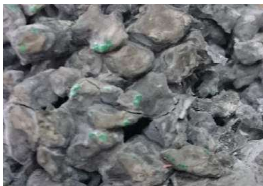
Figura 04 – Bloco de concreto permeável depois de rompido
