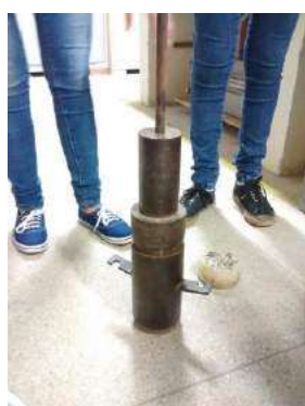
Figura 01 – Compactação do corpo de prova
