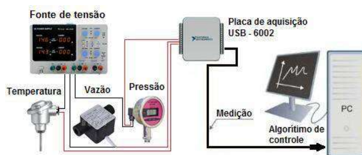
Figura 2: Diagrama de blocos do sistema de supervisão e aquisição de dados
