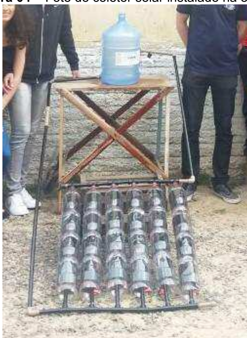
Figura 04 – Foto do coletor solar instalado na escola.
