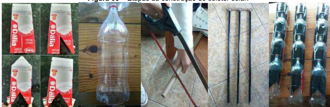
Figura 03 – Etapas da construção do coletor solar.
