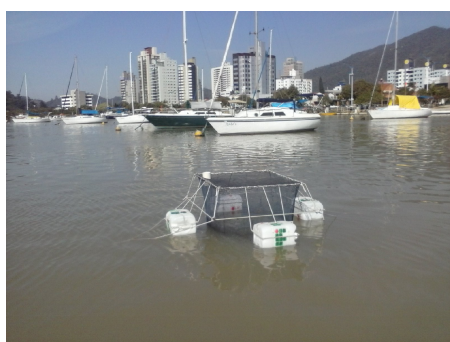
Figura 1 – Tanque-rede construído para o experimento.
