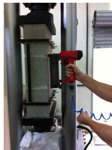
Figura 2 – Detalhe do ensaio de cravação pneumática nos prismas de 3 blocos.
