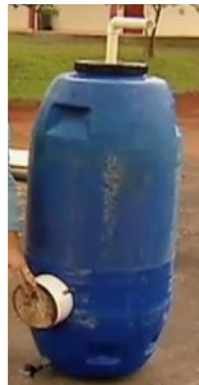
Figura 1 – Biodigestor orgânico caseiro.
