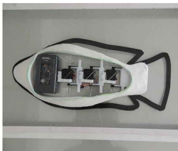
Figura 3 – Protótipo com mecanismo de locomoção e pele a base de silicone
