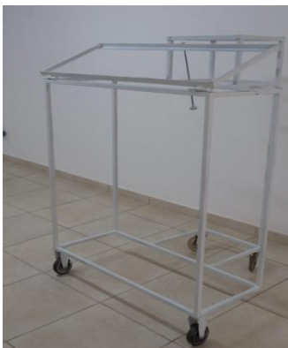
Figura 1 – Suporte para as placas fotovoltaicas em processo de construção. Fonte: arquivo pessoal dos autores.
