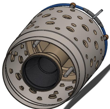
Figura 5 - Câmara de combustão desenhada em ferramenta CAD
