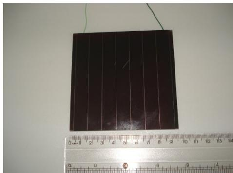
**Figura 2 – Célula Fotovoltaica G24i.**
