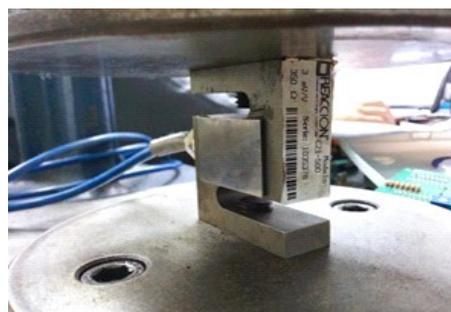
Figura 4 – Célula de carga. Fonte do autor.
