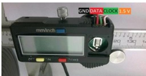
Figura 6 – Conector manufaturado para confecção com o paquímetro digital. Fonte do autor.
