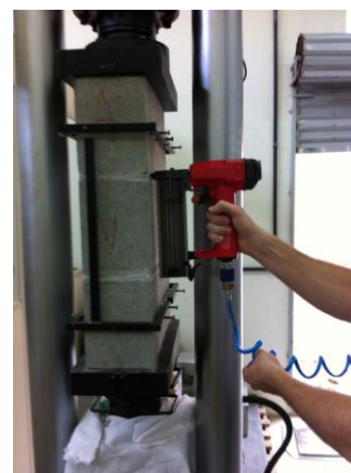
Figura 3 – Ensaio não destrutivo de cravação pneumática de pinos para determinação da resistência à compressão das juntas de assentamento.
