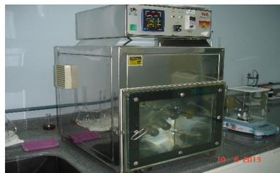
Figura 3 – Máquina de tingir amostras têxteis em laboratório - HT- Alta Temperatura (Metal Working)
