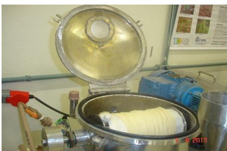
Figura 7 – Máquina de tingir tipo barca protótipo industrial – IFSC- Jaraguá do sul.
