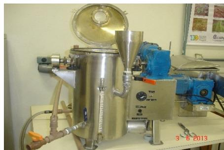
Figura 8 – Máquina de tingir tipo barca protótipo industrial – IFSC- Jaraguá do sul.
