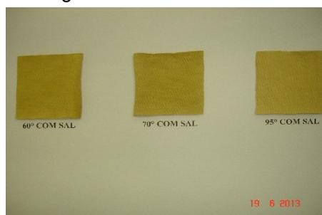
Figura 5 – Amostra de malha tintas com uso de cloreto de sódio (NaCl) como auxiliar.
