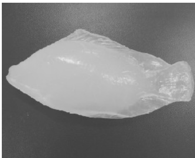
Figura 2 – Peixe Tilápia Rendalli em Silicone, construído em laboratório com uso de moldes.
