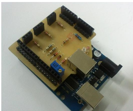
Figura 2 – Placa eletrônica da interface desenvolvida.
